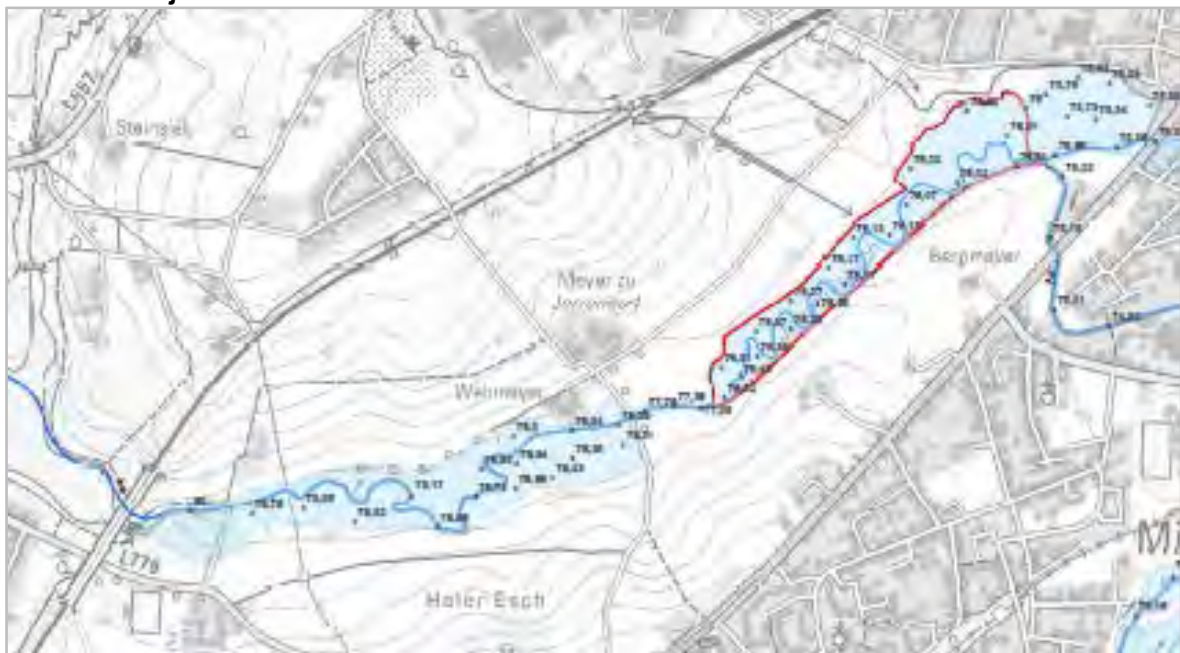
Karte 9: Fünfjähriges Hochwasser im Bereich der östlichen Johannisbachau
