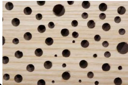
Die Löcher sind sauber gebohrt. Der Abstand zwischen den größeren ist aber zu gering.
