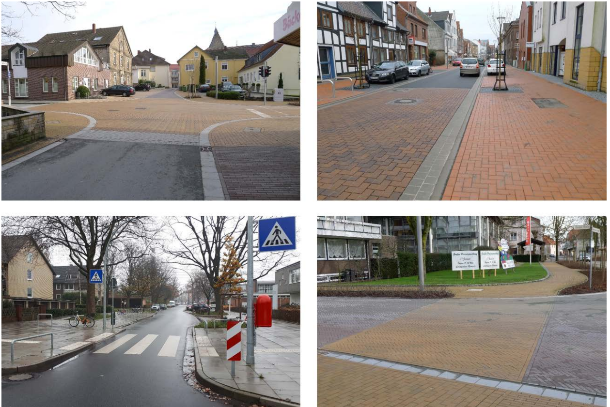
Abb. 41 Beispiele für Aufpflasterungen und vorgezogene Seitenräume
