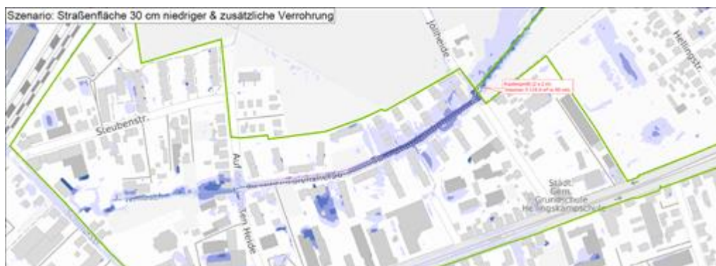
Abb. 83: Überflutungen bei einem extremen Starkregen ( h_N=90 mm) im Bereich der Straße Teichsheide (Bildmitte), bei Absenkung der Straßenfläche um 30 cm und Simulation einer zusätzlichen Verrohrung am östlichen Ende der Straße
