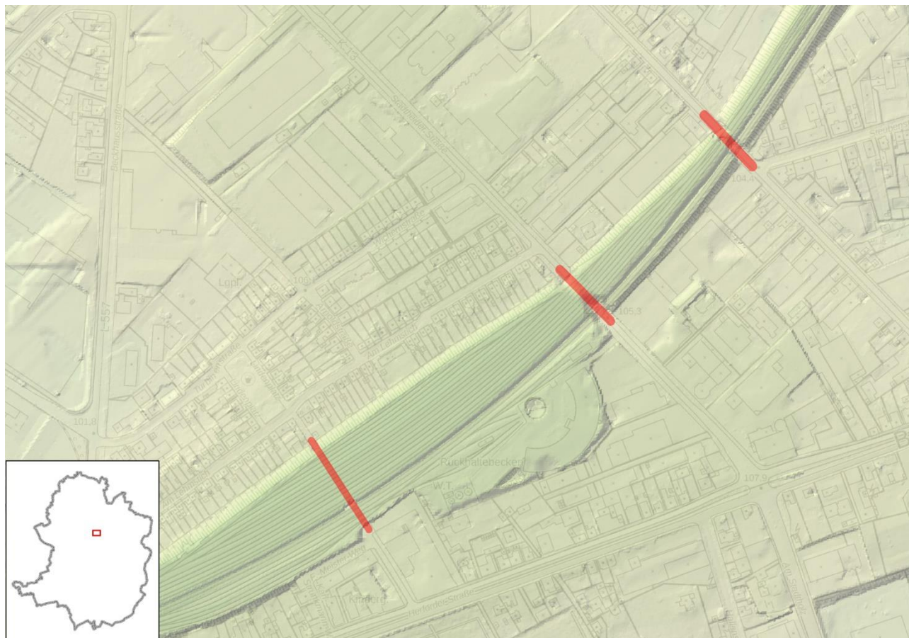
Abb. 61: Durchlässe in einem Bahndamm (rote Linien)
