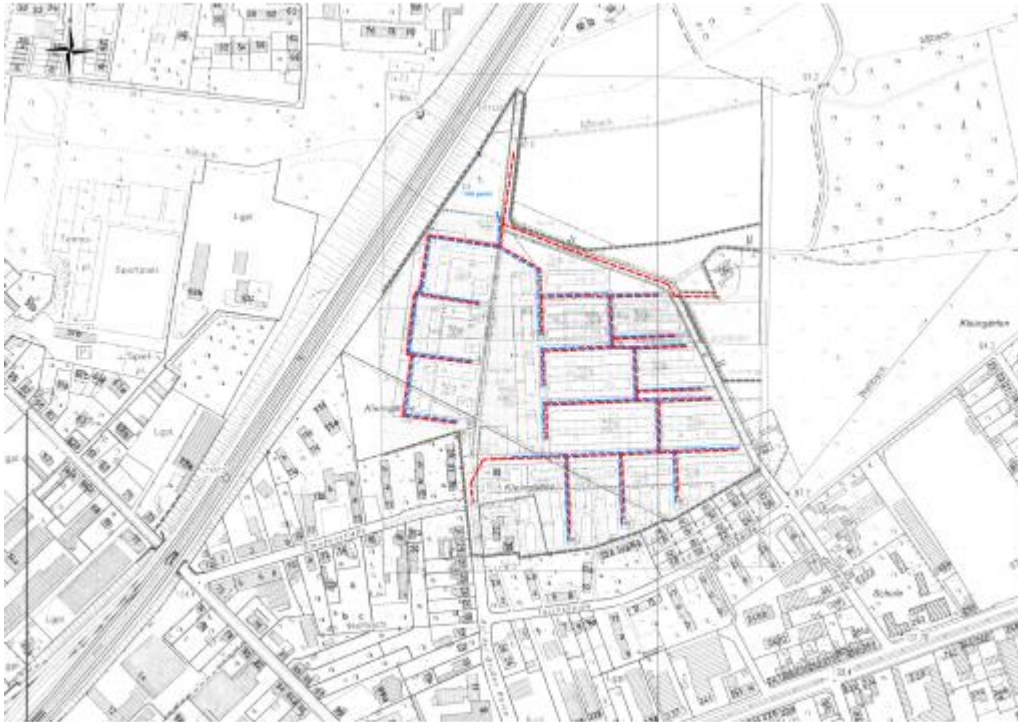
Abb. 79: Geplantes Trennsystem im Bereich des B-Planes Jöllheide
