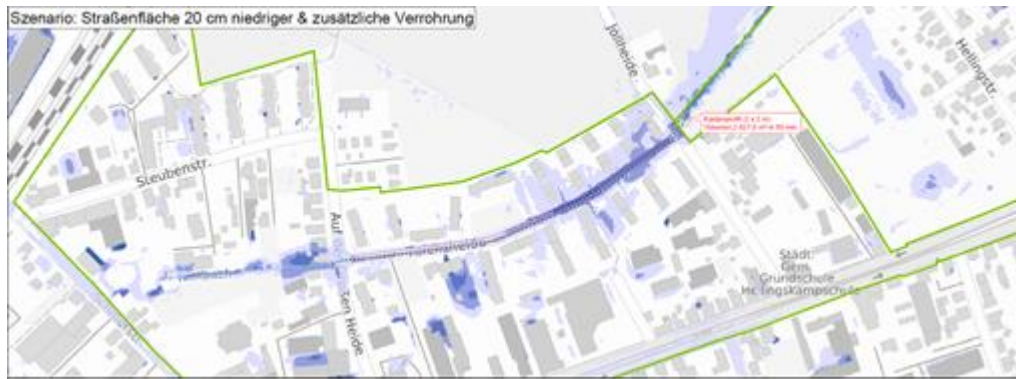
Abb. 82: Überflutungen bei einem extremen Starkregen ( h_N=90 mm) im Bereich der Straße Teichsheide (Bildmitte), bei Absenkung der Straßenfläche um 20 cm und Simulation einer zusätzlichen Verrohrung am östlichen Ende der Straße
